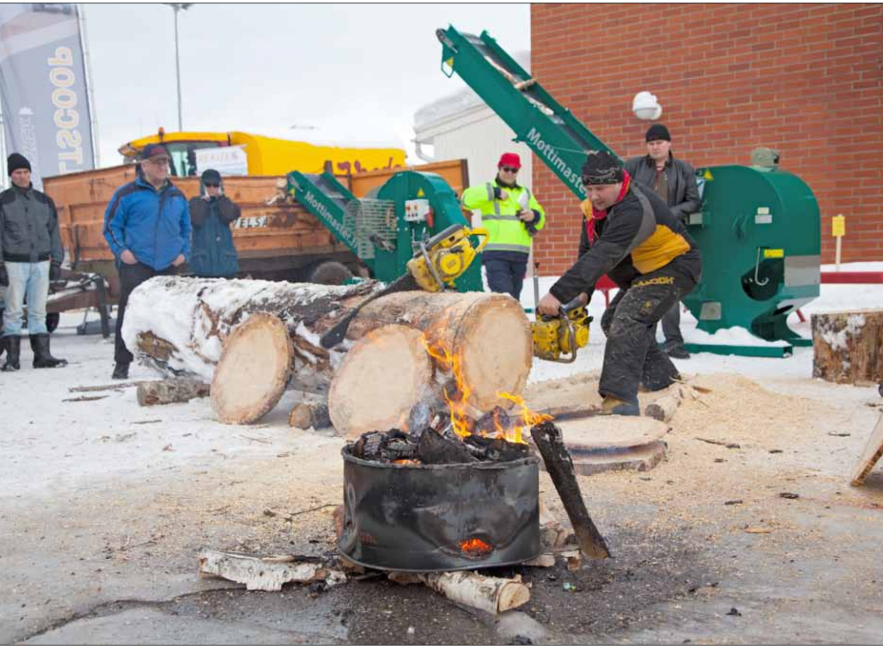
Tuomo Kukkolan McCullogh vuodelta 1962 on järeää tekoa. Painoa on tankattuna 15 kiloa. Kuutiotilavuus on lukemissa 87 kuutiotesenttimetriä ja tehoa irtoaa 6,6 hevosvoimaa.
