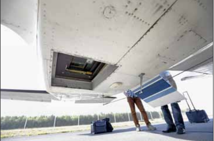
Lähi-infrasignaalia lähettävä keilain on lentokoneen pohjassa.
