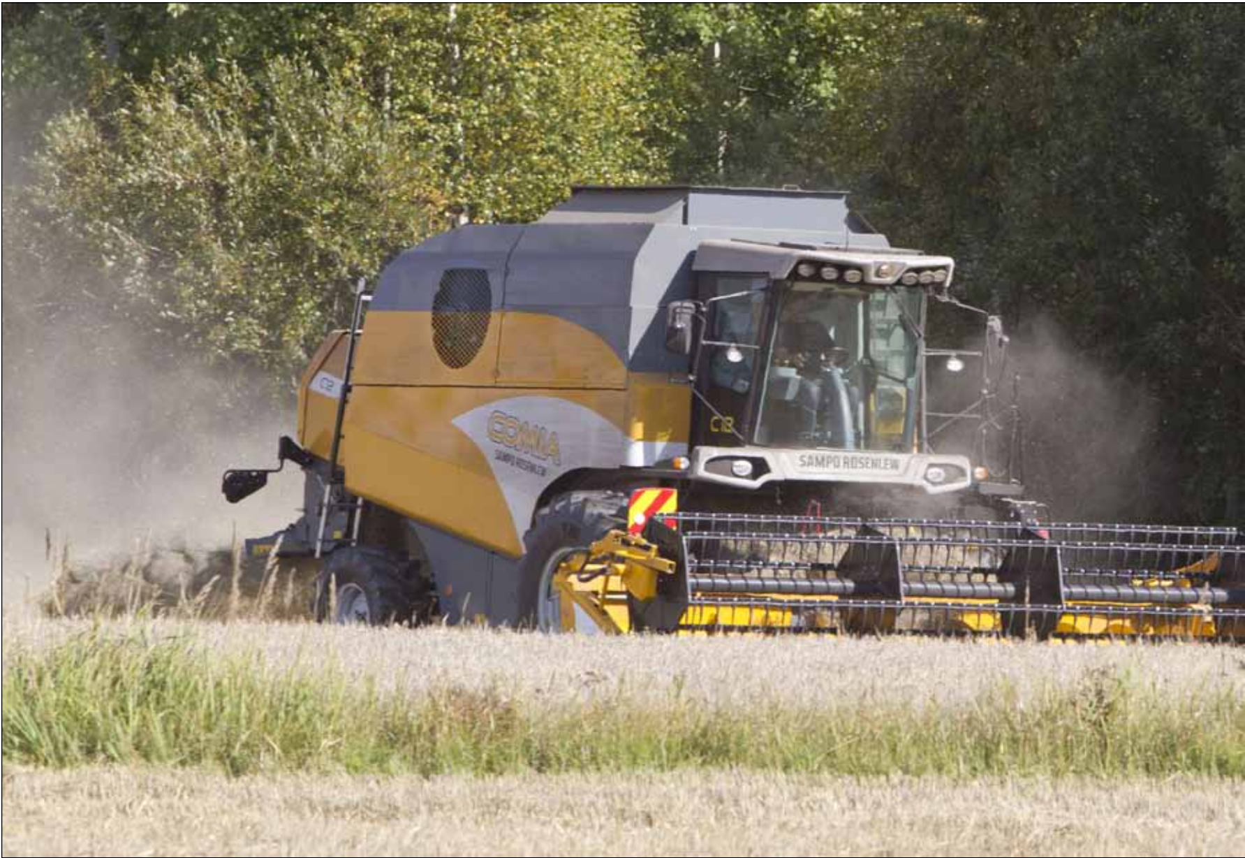
Sampo-Rosenlewin uusi lippulaiva, Comia 12, on parannettu painos vanhasta 3085-mallista. Puintitehoa on karkeasti neljännes enemmän kuin edeltäjässä 12 vuotta sitten. Koneistoa valvotaan ja ohjataan kosketusnäytöltä, joka tulee vakioksi koko Comia-mallistoon.
