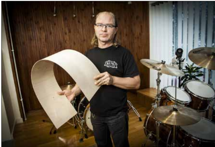
Kumujen puuosat ovat koivuviilua ja -vaneria. Kaksimillimetrinen koivuvaneri taipuu hyvin. Kumuissa suosituin on original-runko, jonka seinämän vahvuus on 3,8 millimetriä.
