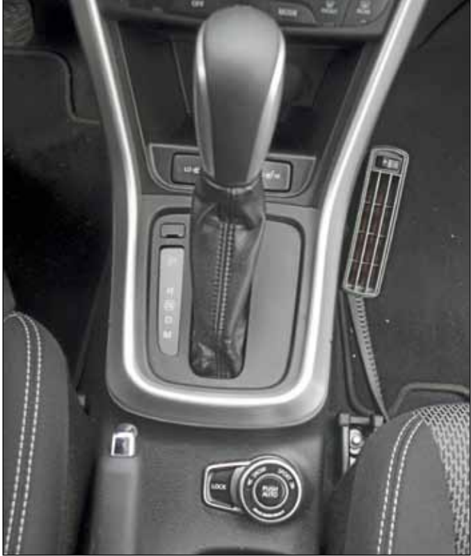
Nelivetojärjestelmän lukitus jakaa voiman tasaisesti etu- ja takapyörille.
