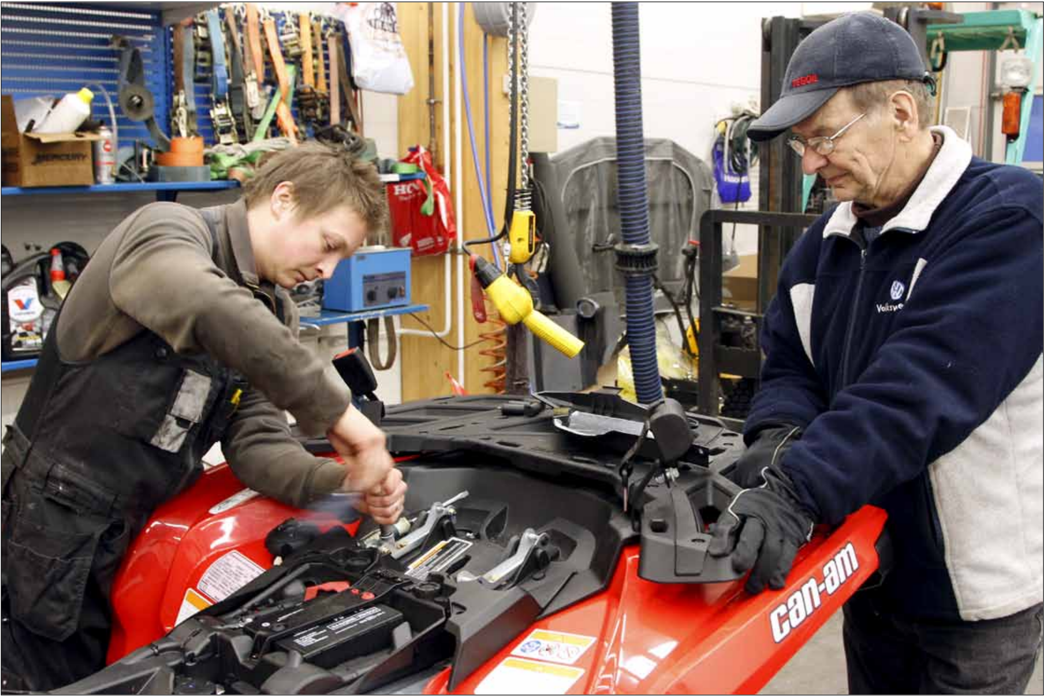
Asentaja Harri Happonen (vas.) tekee ensihuoltoa 10 käyttötunnin jälkeen Matti Väänäsen (oik.) mönkijään Konesolmu Oy:n liikkeessä Kuopiossa. ”Ensihuollon tärkeyttä ei voi liikaa korostaa”, Happonen sanoo.
