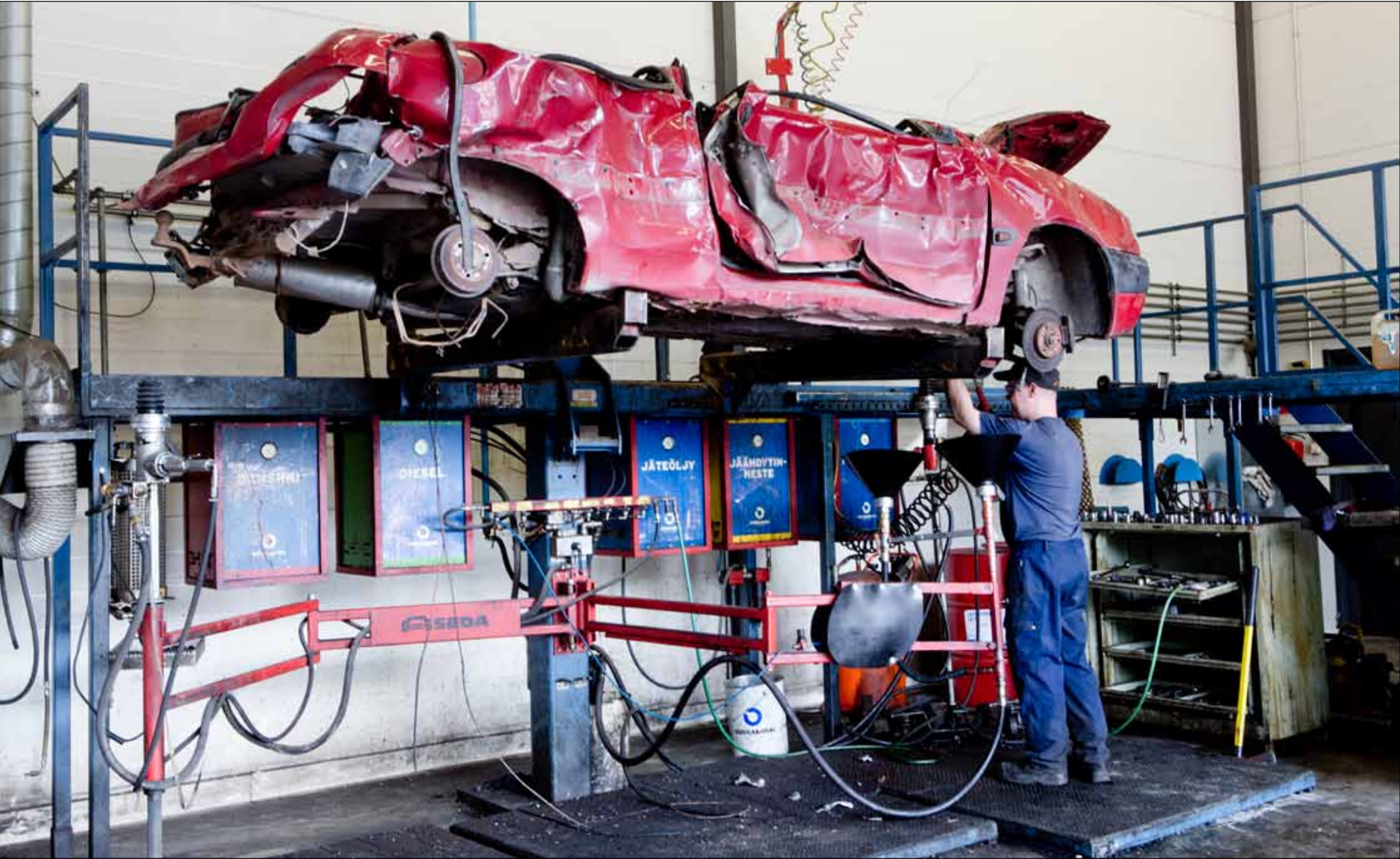
Materiaalinkäsittelijä Jouni Matilainen esikäsittelee autoa murskausta varten Kuusakosken tehtaalla Heinolassa.
