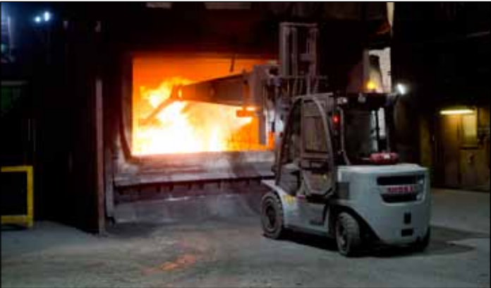
Autoromua työnnetään sulattamoon, jossa se muuttuu nopeasti nestemäiseksi.
