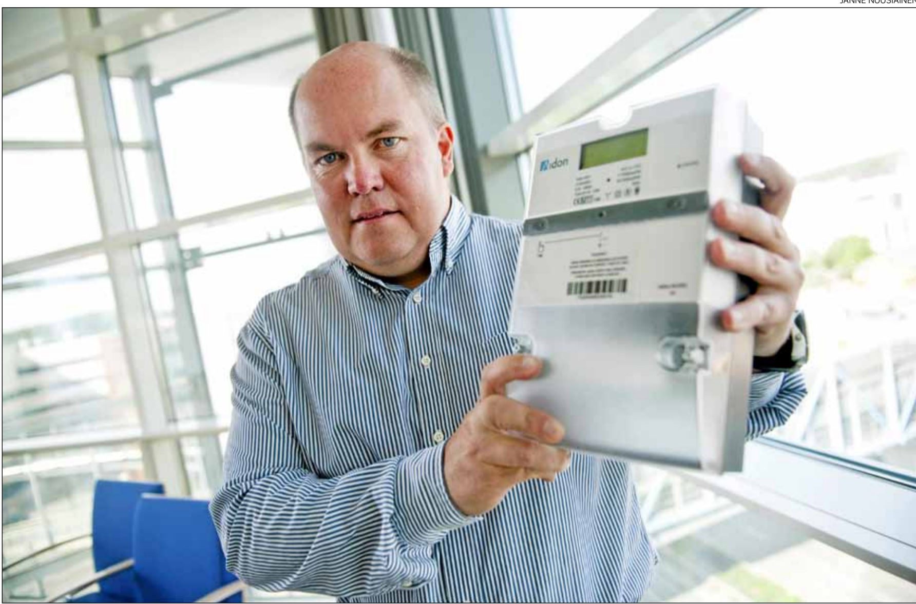
Petteri Heinänen käsissä on Aidonin energiapalvelulaite. Se tuottaa tunnettaita tietoa kodin sähkönkulutuksesta.
