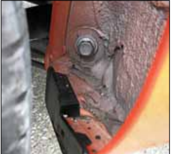
Pyöräkotelon alareunan suojaus on puutteellinen.
