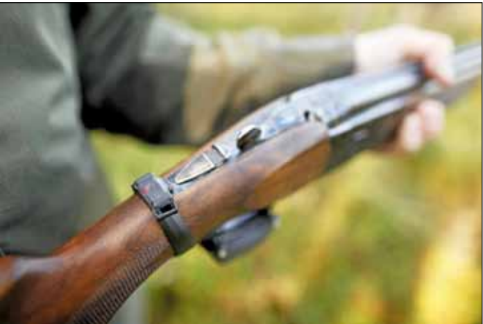
Mikla Guard-laite hälyttää ääni- ja valomerkillä viiden sekun-nin viiveellä, jos varmistin on unohtunut pois päältä.
