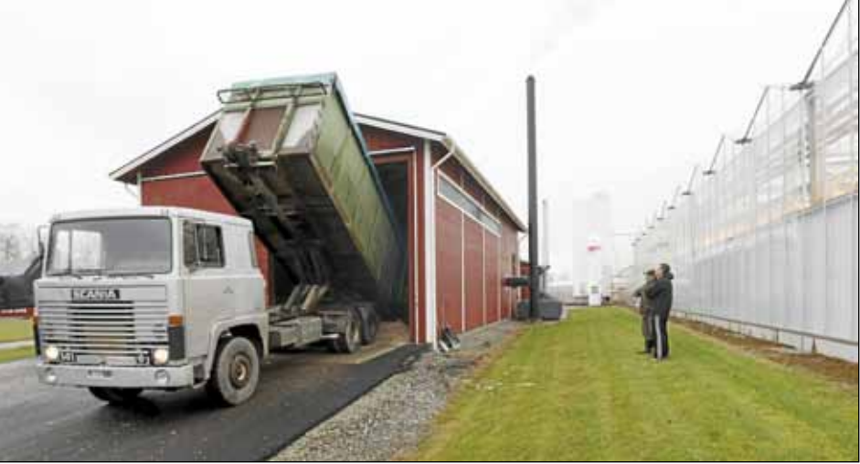
Sotkamon kantokone tuo Parkinniemeen haketta 44 kuutiometrin erissä. Kuusi tankopurkainta syöttää haketta kattilaan. Lämpökeskuksen on toimittanut kotimainen Biofire Oy. Puutarhuri Jyrki Tervosen mukaan järjestelmä on toiminut muutamaa häiriötä lukuun ottamatta hyvin. Jos tulipalo syttyy, sen eteneminen estetään syöttöruuvissa olevalla varasammutusjärjestelmällä.
