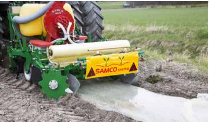
Irlantilaisen Samcon valmistama kylvökone tekee kerralla kolme työvaihetta.
