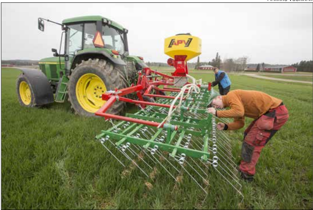
Bernerin tiistaina Erik Perklénin tilalle perustetulla kokeella testataan kerääjäkasvin kylvöä syysvehnän oraalle. Kuvan laite on varta vasten koetta varten rakennettu asentamalla pintaakeen päälle heinänsiemenenkyvläite. Erik Perklén ja Mickel Nyström säätävät äkeen harausvoimakkautta.
