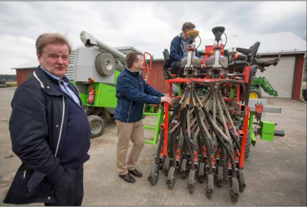
Koeruutujen kylvökone on suunniteltu Kotkaniemeä varten, Raimo Kauppila kertoo. Sillä voidaan kylvää noin 400 ruutua päivässä.
