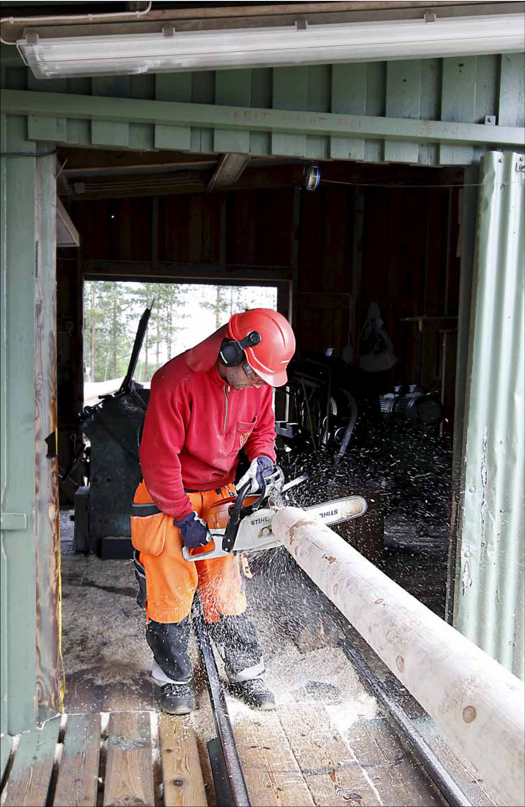
Pylvään pinta on sorvattu tasaiseksi. Tamas Juhasz sahaa vielä yläpäädyn asiakkaan toiveiden mukaiseksi, ennen kuin tuote on valmis vientiin.
