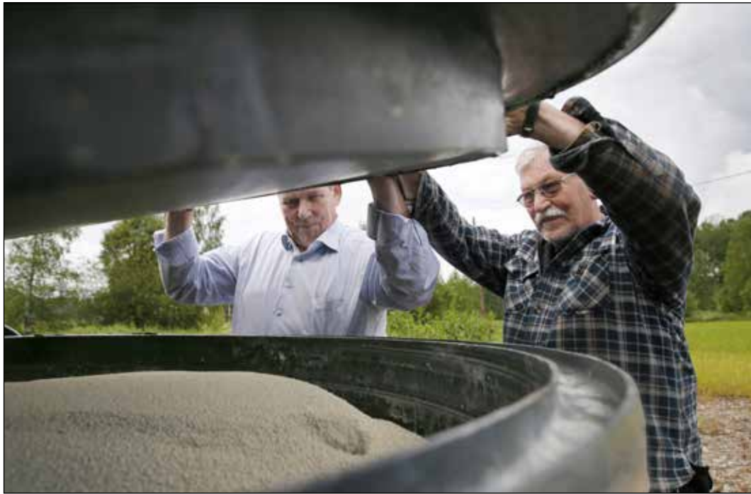
Tapio Salminen (vas.) Saloy Oy:sta ja taipalsaarelainen Pertti Tujula tarkastelevat fosforinpoistolaitteen rakennetta. Laitteeseen mahtuu kerralla kaksi tonnia rautasulfaattia. Se riittää noin puoleksitoista kuukaudeksi.
