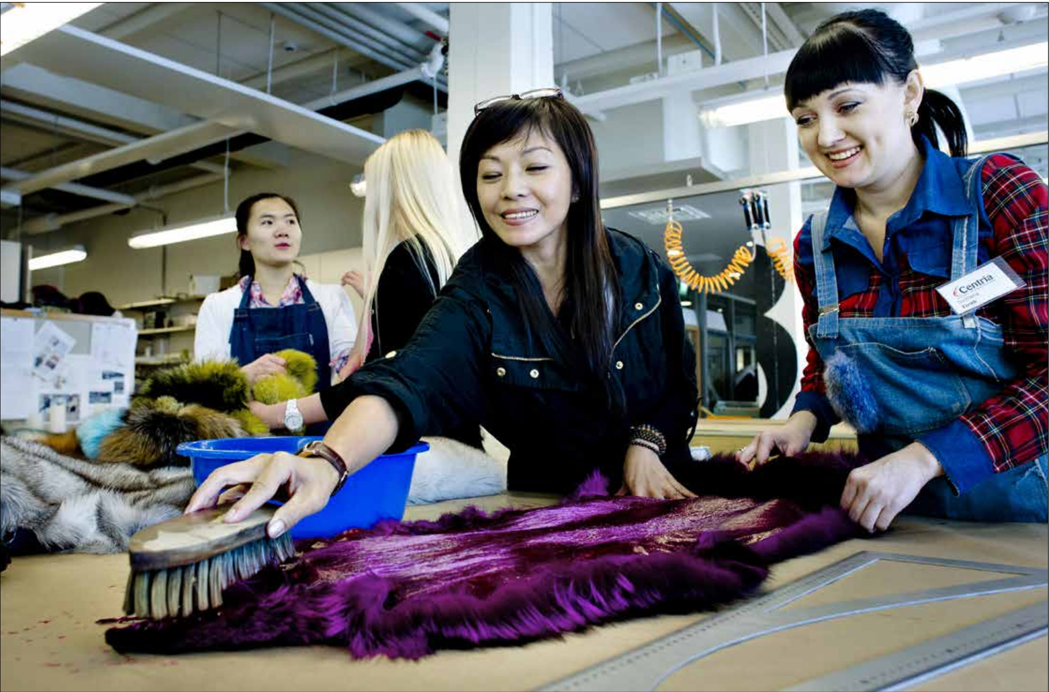
Kiinalainen Zhi Liao ja ukrainalainen Svetlana Tirak perehtyvät värjätyn sinikettuturkiksen kostuttamiseen ja naulaukseen. Taustalla keskustelevat vietnamilainen Thu Pham ja suomalainen Josefine Döfnäs.
