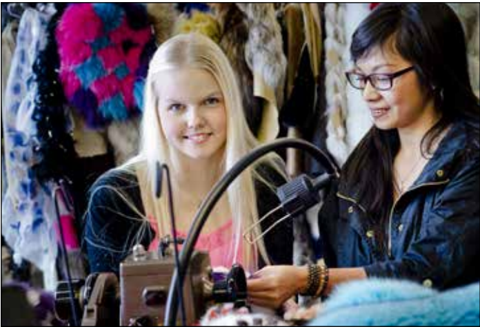
Josefine Döfnäs Kruunupyystä ja Zhi Liao Kiinasta paneutuvat galoneeraukseen eli nahan ja turkiksen yhdistämiseen ompelukoneella.
