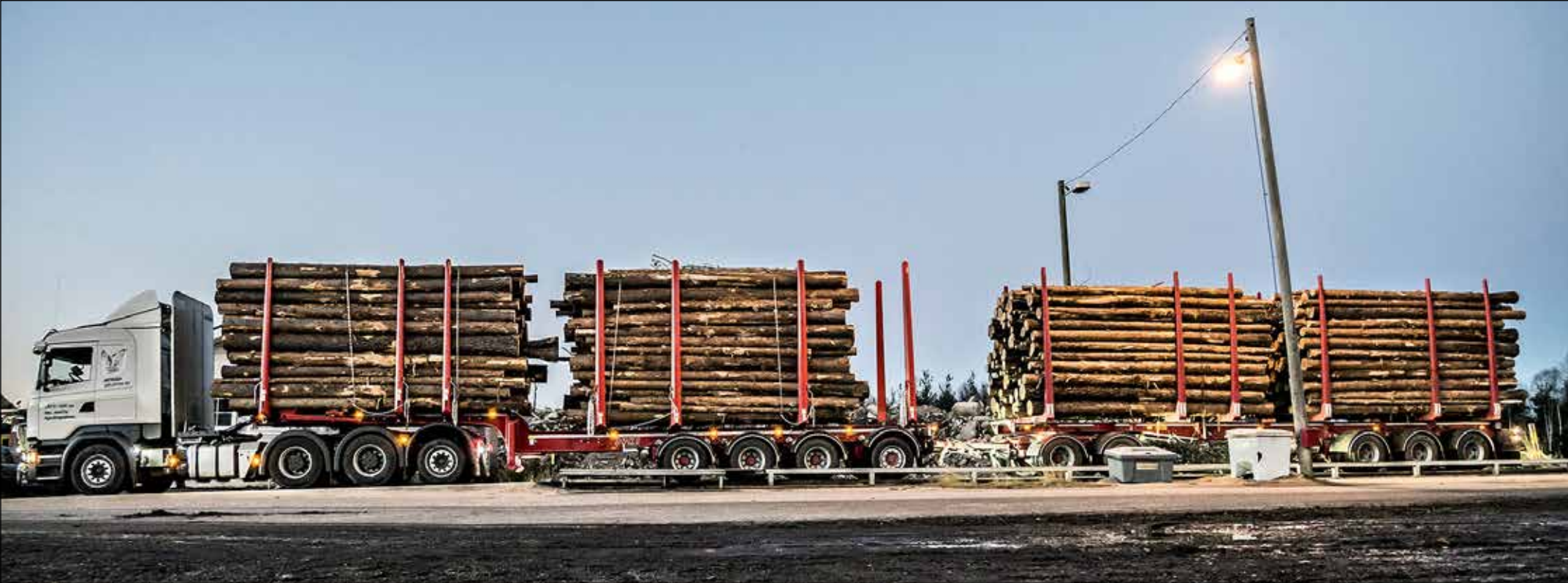
Kuormakokojen kasvattaminen parantaa kannattavuutta. Metsähallitus ajattaa Rovaniemelle puuta 104-tonnisella jättirekalla. Yhdistelmä koostuu 4-akselisesta vetoautosta, 4-akselisesta puoliperävaunusta sekä 5-akselisesta perävaunusta.
